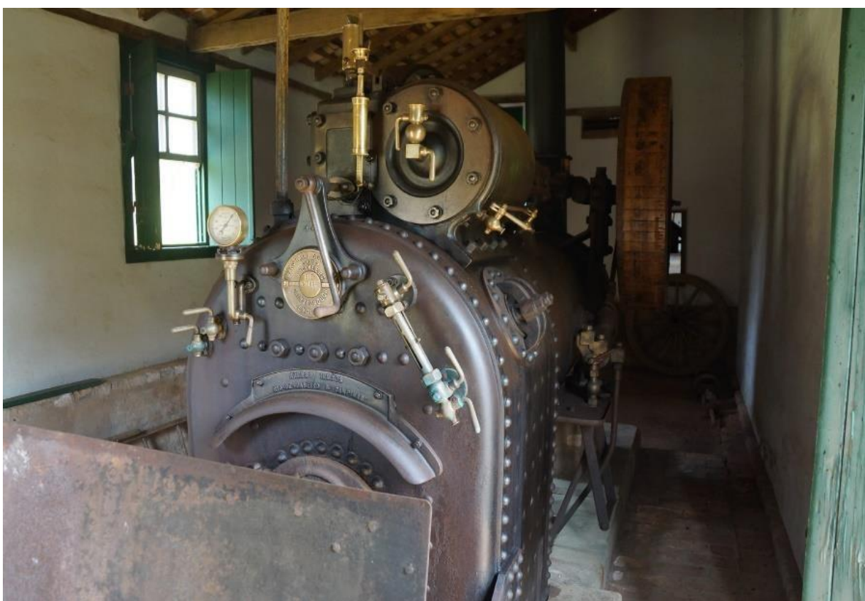
Locomotiva a vapor usada para movimentar uma máquina de beneficiar café, comprada de uma fazenda perto de São João da Boa Vista (SP). A aquisição dessa locomotiva foi feita no início do século XX. Sítio da Família Stivanin, Andradas/MG. Acervo da Ponte entre Culturas/MG.
