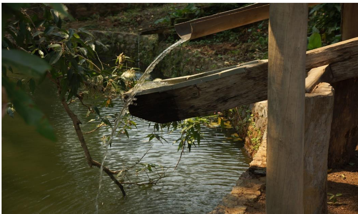
Parte de trás de um monjolo destinada a capitar a água canalizada para tal fim. Tanto o peso da água nessa parte traseira, quanto sua posterior descarga ao descer, são responsáveis pelo movimento do mecanismo, destinado pilar grãos. Sítio da Família Stivanin, Andradadas/MG. Acervo da Ponte entre Culturas/MG.
